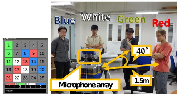
図1 「早言い」クイズゲーム HATTACK25 におけるロボット司会者 (HRP-2) と4人のプレイヤー
